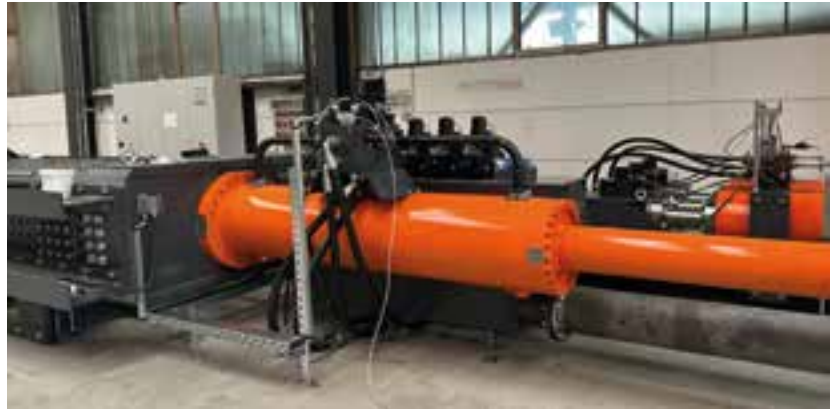
■ Leistungsstarkes Hydraulikaggregat als »Herzstück« © Maurer SE
