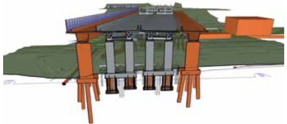
4 Ansicht der Pfeilerachse 20 im Modell inklusive Baubehelfe © Hochtief Infrastructure GmbH
