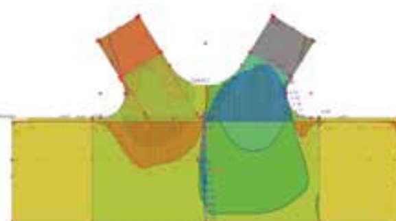
10 Exemplarischer Verlauf der Normalspannungen in vertikaler Richtung eines Fachwerkknotenpunkts © bulicek + ingenieure gmbh
