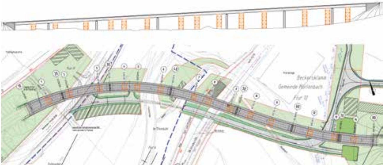
5 Baustraße und Hilfspfeiler der Talbrücke Reisen © Hessen Mobil
