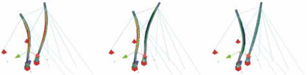
18 Knickfiguren der Pylone: asymmetrisch quer, symmetrisch quer, längs © BPR Dr. Schäpertöns Consult GmbH & Co. KG
