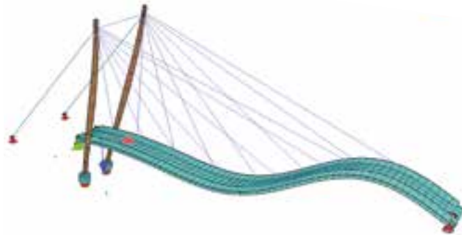
19 Zweite vertikale Eigenform mit f = 2,30 \text{ Hz} © BPR Dr. Schäpertöns Consult GmbH & Co. KG
