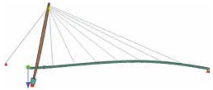
17 Prinzip des Überbauanhebens durch Nachspannen der Rückverankerung © BPR Dr. Schäpertöns Consult GmbH & Co. KG
