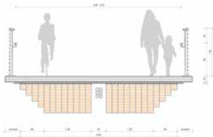
4 Regelquerschnitt © Ingenieurbüro Miebach
