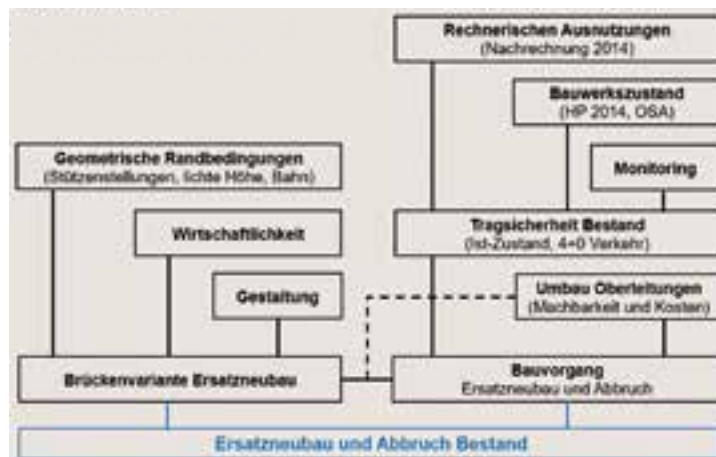
5 Aufgabenstellung der Variantenuntersuchung © Dr. Schütz Ingenieure
