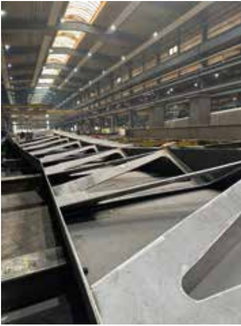
5 6 7 8 Vorfertigung aller Stahlbauteile im Werk © Philipp Schiffer
