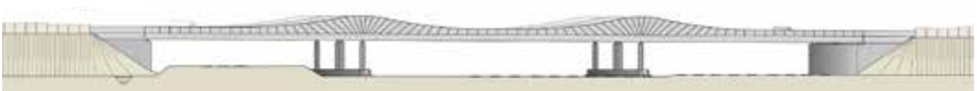
7 Ansicht: Variante Trogbrücke © Dr. Schütz Ingenieure
