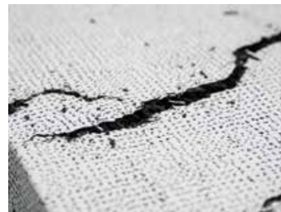
Faserbewehrung im ultrahochfesten Beton © Eidgenössische Materialprüfungs- und Forschungsanstalt
