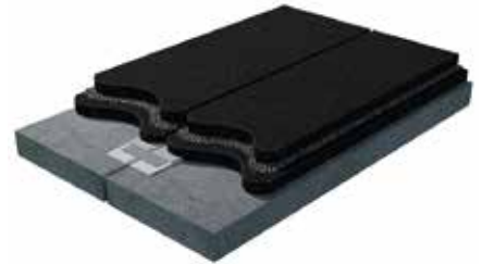
Aufbringen und Verteilen des niedrigviskosen Harzes © Sika Deutschland CH AG & Co KG
