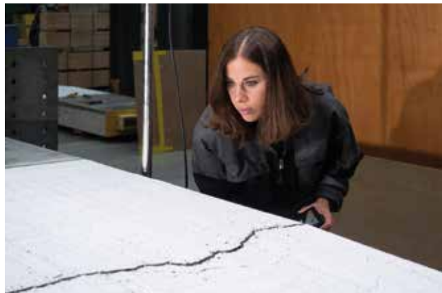
Großversuch: Betonplatte unter Spannung © Eidgenössische Materialprüfungs- und Forschungsanstalt
