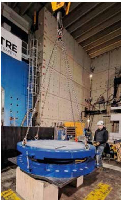
Lagertests im Eucentre in Pavia © Maurer SE
