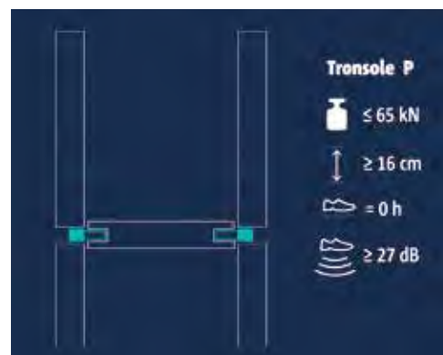
Zweites Trittschalldämmelement zum trockenen Einbau © Schöck Bauteile GmbH
