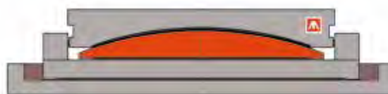
Lagerquerschnitt mit innerer Kalotte (orange) © Maurer SE
