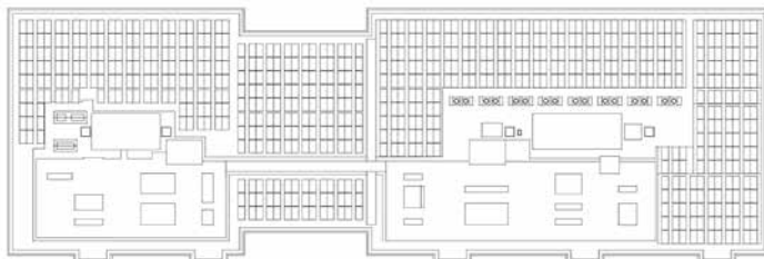
Dachaufsicht mit Photovoltaik- und Solarthermie-Modulen sowie Terrassen
