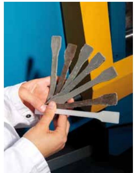
Prüfung der Materialkennwerte verschiedener »Recyclingmischungen« © Technische Universität Berlin
