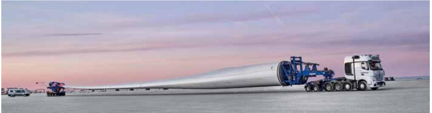
Schwerlastkombination zur Beförderung © TII Scheuerle
