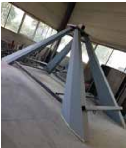
9 Vorfertigung der V-Stützen im Werk © tragwerkstatt ZT gmbh
