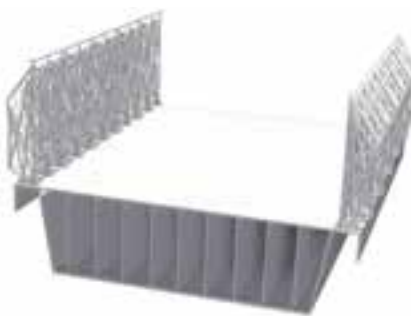
■ Hohlkammerkonstruktion aus Flachsfasern © Smart Circular Bridge
