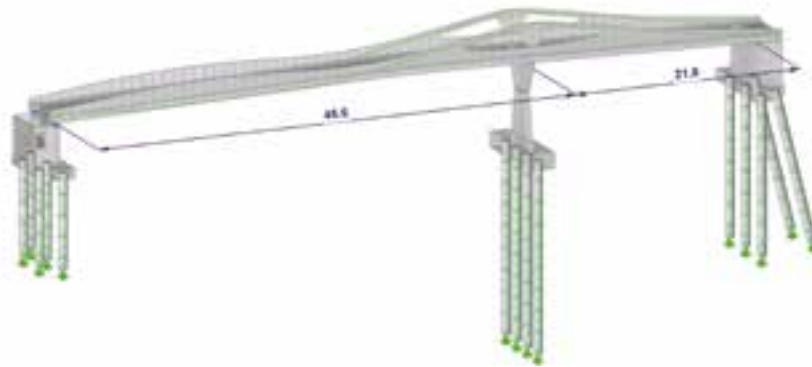
8 Finite-Elemente-Modell: Geometrie und Verformung © Engelsmann Peters GmbH
