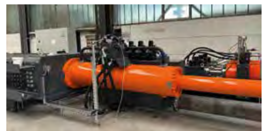
Hydraulikaktuator zur Steuerung der Prüfpresse © Maurer SE
