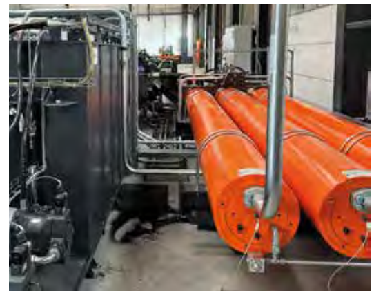
Leistungsstarkes Hydraulikaggregat als »Herzstück« © Maurer SE
