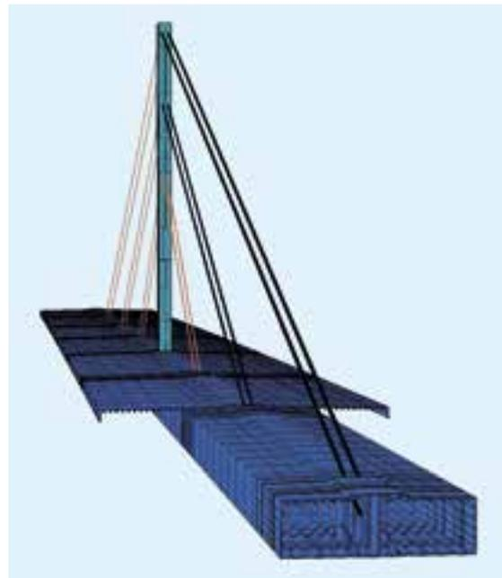
9 Globales Stabwerkmodell zur Berechnung der Rückbauzustände
