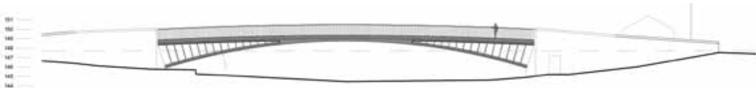
4 Aufgeständerte Bogenbrücke mit obenliegender Fahrbahn © Knight Architects
